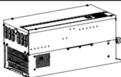
步骤2：拆卸底部线缆进口钣金及固定螺钉
