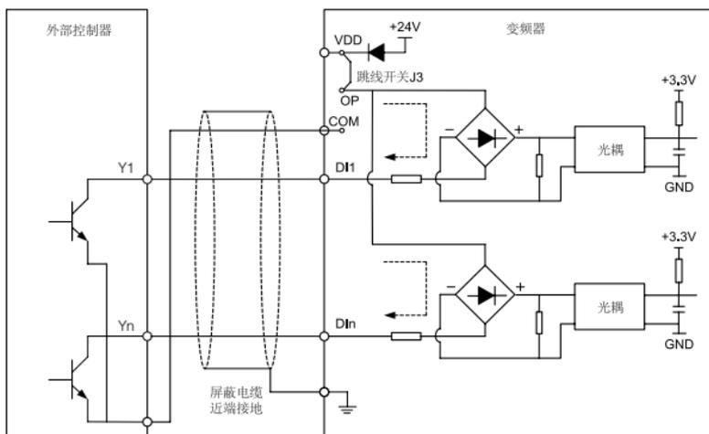
这种接线方式必须把跳线开关J3的OP连接到+24V上（变频器出厂跳线开关J3默认为NPN模式，即OP连接+24V）。
