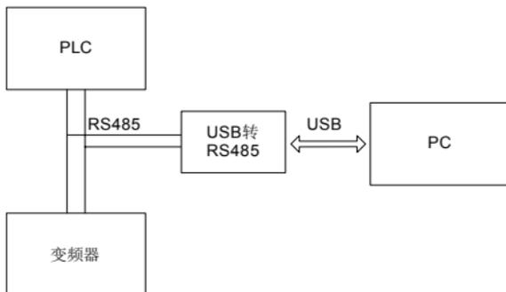
Modbus调试系统连线图
