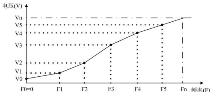
图中，C01.55[0]~C01.55[5]分别对应V0~V5，C01.56[0]~C01.56[5]分别对应F0~F5，Vn是电机额定电压，Fn是电机额定频率。
