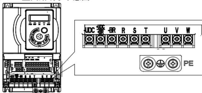
三相380V 4.0 ~ 22kW机型主回路端子示意图
