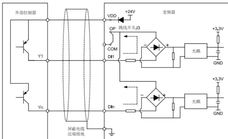
这种接线方式必须把跳线跳线开关J3的OP连接到COM上（即跳线开关J3使用PNP模式），否则不能正常工作。
