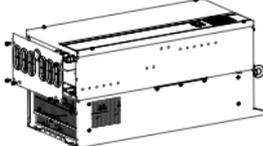
步骤3：将橡胶件从底部钣金上移到底座
